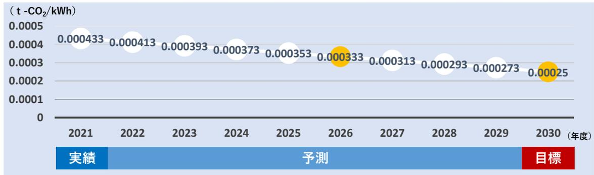
図8 目標値算出に使用した電気使用量の排出係数
